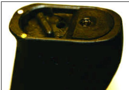
Прокалывание баллончиков выглядит следующим образом - снаряженный ими пистолет нужно упереть "фальшстволом" (клапаном) в деревянный предмет и сильно надавить (а точнее сказать, стукнуть). Перед каждым выстрелом пистолет надо взводить, нажав на курок, пистолет уже во взведенном положении с пулей на линии огня разрядить невозможно. На наш взгляд, этот момент разработчику еще нужно продумать.
