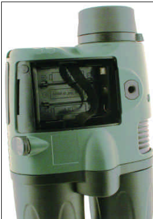
Ranger 5x42 работает автономно, от батарей (аккумуляторов) типа AA. Элементы питания располагаются в специальном контейнере, который затем помещается в батарейный отсек прибора. В комплект включен дополнительный контейнер, который можно заранее "зарядить" батареями, чтобы потом облегчить их замену в темноте.
